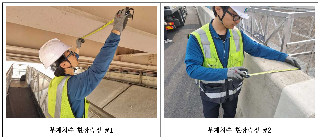
【사진 1.2.1】 부재 현장측정 전경
